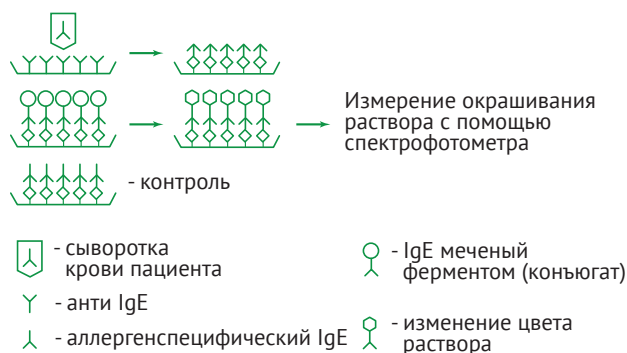
Рис. 12. Схема неконкурентного анализа для определения аллергенспецифических IgE.
