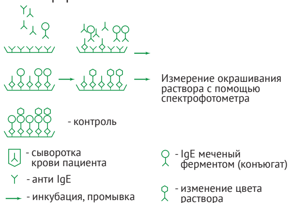
Рис. 13. Схема конкурентного анализа для определения аллергенспецифических IgE.
